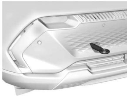
2. Instale la armella de arrastre en el receptáculo y gírela hasta que esté completamente apretada. Al retirar el ojo de remolque, vuelva a instalar la cubierta en la posición original.
