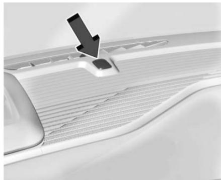
El sensor de luz está en la parte superior del tablero de instrumentos. No cubra el sensor.
