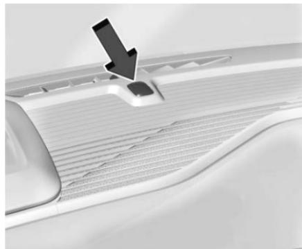
Cuando el cable de carga está conectado, aparece un color para indicar el estado de carga.
