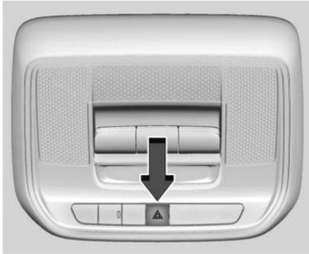
**⚠** : Presione este botón en la consola superior para encender y apagar intermitentemente las luces direccionales delanteras y traseras. Esto advierte a otros que usted está teniendo problemas. Presione nuevamente para apagar las intermitentes.
