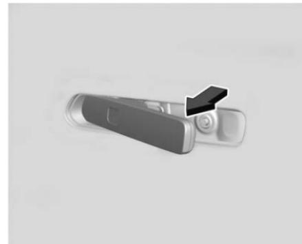
Cuando las manijas de las puertas delanteras estén giradas hacia afuera, toque la parte trasera de una manija para desbloquear todas las puertas.
