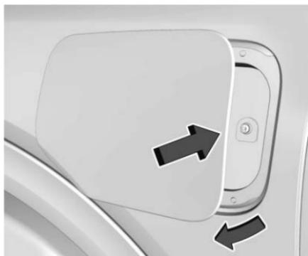
2. Empuje el borde trasero de la puerta del puerto de carga y suéltelo para abrir la puerta.
