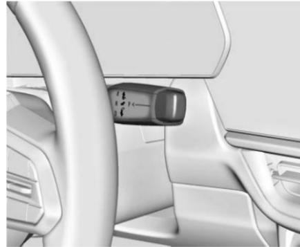
El vehículo usa una unidad eléctrica de impulso. El patrón de cambios se muestra en la parte delantera de la palanca de cambios. La posición de velocidad seleccionada se iluminará en rojo en la palanca de cambios, mientras que todas las demás se proyectarán en blanco. Si el cambio no es inmediato, como en condiciones muy frías, el indicador en el interruptor de cambios puede parpadear hasta que esté completamente conectado.
