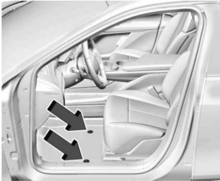
1. Tire hacia arriba de la parte trasera del tapete para desacoplar cada uno de los retenes y retire el tapete.
