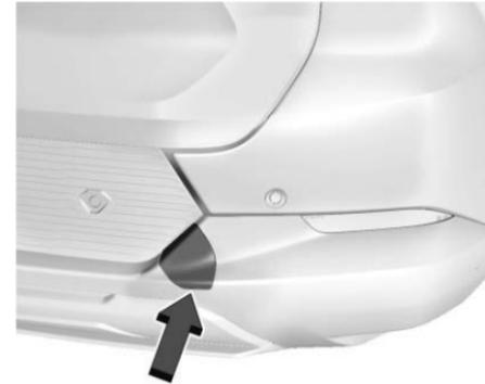
1. Abra cuidadosamente la cubierta en la fascia usando la ranura pequeña que guarda el receptáculo de la argolla de remolque.
