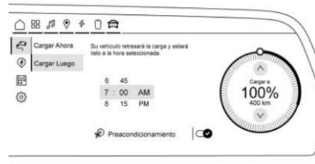
En lugar de cargar inmediatamente al nivel de carga deseado, puede optar por retrasar la carga al vehículo y completarla a la hora de salida deseada. Esta puede ser una opción más económica y un uso más eficiente de la energía al cargar en casa. Para usar este modo, toque Cargar más tarde en la pantalla Siguiendo carga. Con Cargar más tarde seleccionado, la pantalla Cargando muestra:
