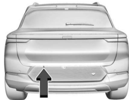
Para acceder al cilindro de bloqueo de llave de la puerta trasera, retire el tapón de cubierta e inserte la llave mecánica en el cilindro. Gire para desbloquear. Consulte *Llaves* ⇨ 6.
