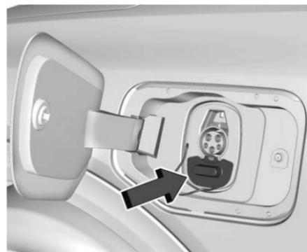
3. Desasegure la cubierta para polvo de carga CD y bájela completamente.
