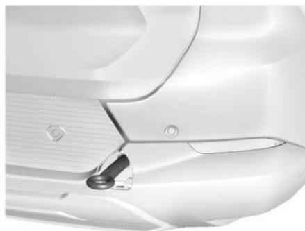
2. Instale la armella de arrastre en el receptáculo y gírela hasta que esté completamente apretada. Al retirar el ojo de remolque, vuelva a instalar la cubierta en la posición original.
