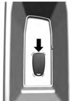
4. Abra la consola central. Coloque la llave remota en la ubicación de respaldo con los botones viendo hacia abajo.
