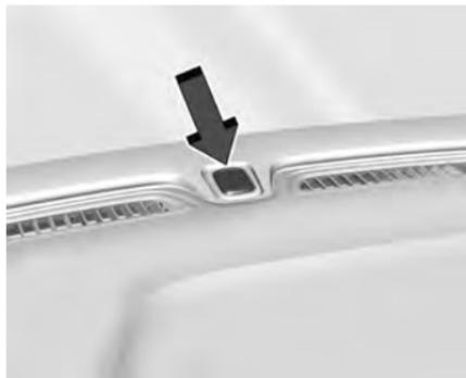
El vehículo tiene un Indicador de estado de carga (CSI) en el centro del tablero de instrumentos cerca del parabrisas. Cuando el vehículo se conecta y la energía del vehículo está apagada, el CSI indica lo siguiente:
