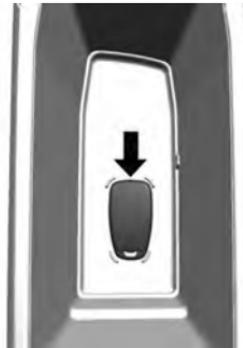
1. Abra la consola central. Coloque la llave remota en la ubicación de respaldo con los botones viendo hacia abajo.
