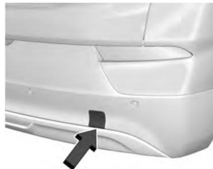
Abra cuidadosamente la cubierta en la facia usando la ranura pequeña que guarda el receptáculo de la argolla de remolque.
