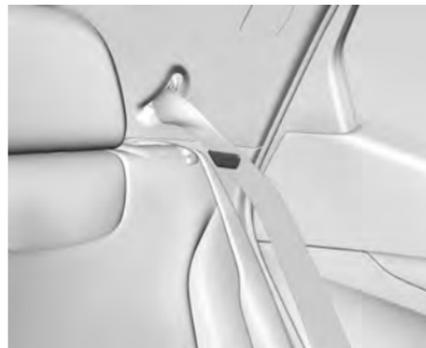
1. Asegúrese que el cinturón de seguridad esté en el sujetador del cinturón de seguridad en la moldura lateral del vehículo.
