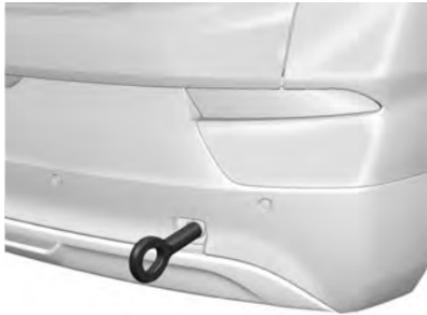
Instale la armella de arrastre en el receptáculo y gírela hasta que esté completamente apretada. Al retirar el ojo de remolque, vuelva a instalar la cubierta en la posición original.
