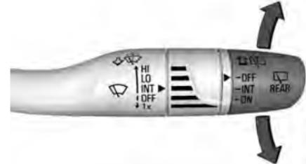
Los controles se encuentran en el extremo de la palanca del limpiaparabrisas.
