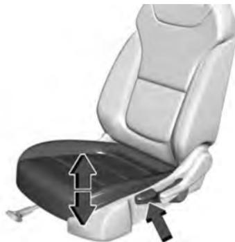
Mueva la palanca en la parte exterior del asiento hacia arriba o abajo para ajustar manualmente la altura del asiento.
