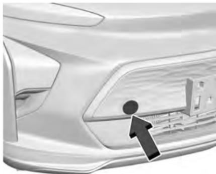
Abra cuidadosamente la cubierta en la facia usando la ranura pequeña que guarda el receptáculo de la argolla de remolque.
