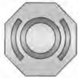
El depósito del cilindro maestro de frenos se llena con líquido de frenos DOT 4 aprobado por GM, como se indica en el tapón del depósito. Vea en *Resumen de compartimiento debajo del cofre* ⇨ 247 la ubicación del depósito.
