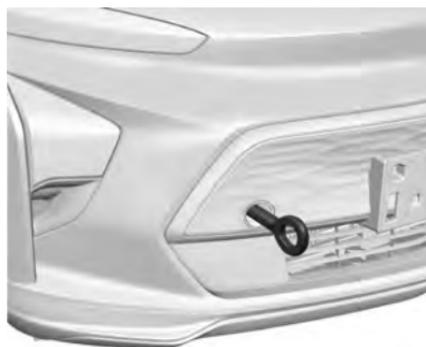
Instale la armella de arrastre en el receptáculo y girela hasta que esté completamente apretada. Al retirar el ojo de remolque, vuelva a instalar la cubierta en la posición original.
