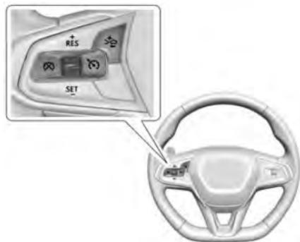
: Oprima para encender y apagar el sistema de control de velocidad constante. Se enciende un indicador blanco en el grupo de instrumentos cuando se enciende el control crucero.
