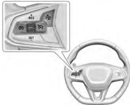
: Presione para encender o apagar el sistema. El indicador se pone blanco en el grupo de instrumentos al activarse el ACC.
