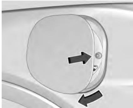
2. Empuje el borde trasero de la puerta del puerto de carga y suéltelo para abrir.
