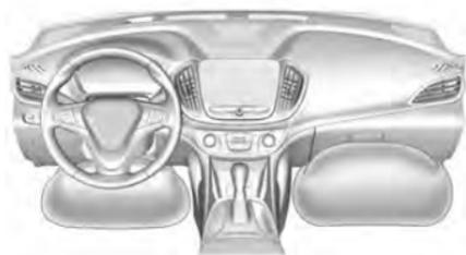
La bolsa de aire de rodillas del conductor está debajo de la columna de dirección. La bolsa de aire de rodillas del pasajero está debajo de la guantera.
