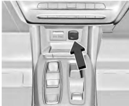
El vehículo tiene una toma de corriente para accesorios en la columna central inferior debajo del control climático.
