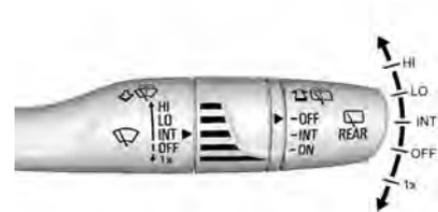
La palanca del limpiaparabrisas/lavador está en el costado de la columna de dirección. Con el vehículo encendido, mueva la palanca del limpiaparabrisas para seleccionar la velocidad del limpiador.
