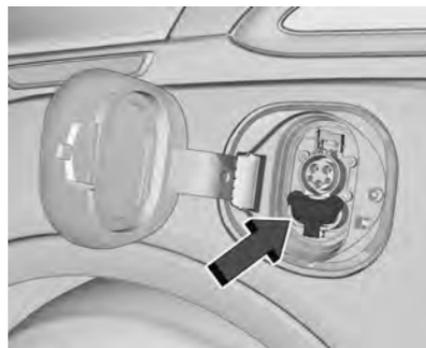
4. Desasegure la cubierta para polvo de carga CD y bájela completamente.
