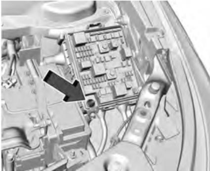
**Terminal positiva (+) de batería descargada**
