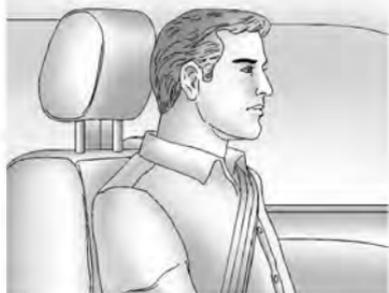
Ajuste las cabeceras de tal forma que la parte superior de la misma esté a la misma altura que la parte superior de la cabeza del ocupante. Esta posición reduce la probabilidad de una lesión de cuello durante un accidente.
